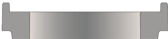
Réhausse sous cadre emboitable H200 mm
